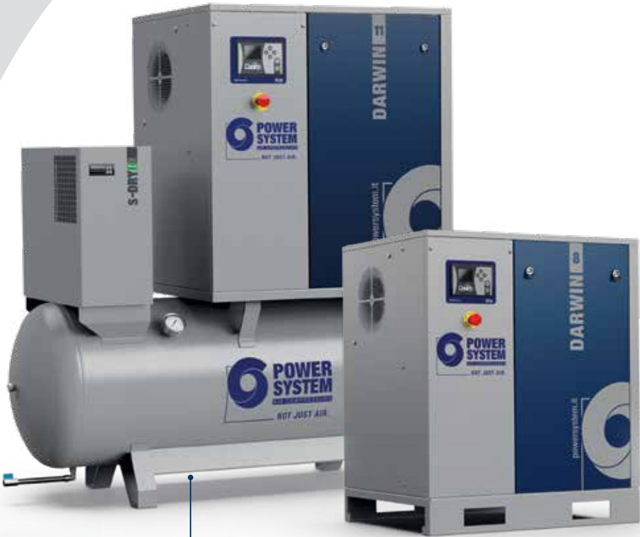
DARWIN-E 8 - 11 - 15 7.5 - 11 - 15 kW ELECTRONIC - LOGIN Mini (star-delta start)
